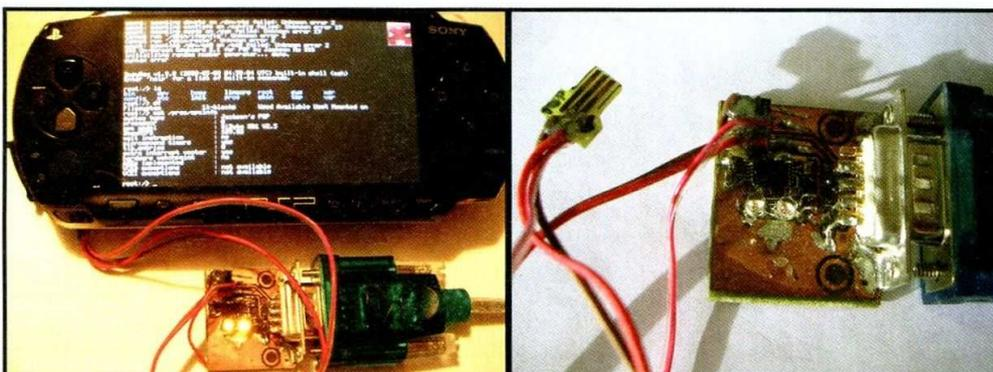
Figure 4 : Circuit de conversion RS232-connecteur série de la PSP, à côté du connecteur jack audio. Il s'agit simplement d'un MAX3232 ou équivalent transformant les niveaux  $\pm 12$  V en 0-3,3 V. Ce montage permet de communiquer au moyen de minicom par exemple avec un système GNU/Linux sur PSP lorsqu'une console est connectée au port série `/dev/ttyS2`.
